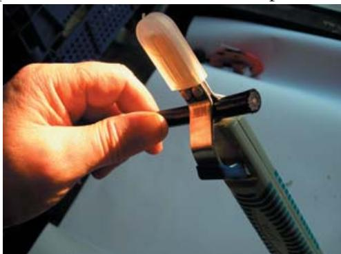
*photo 2 : dénuder au moyen d'un couteau à dénuder*
