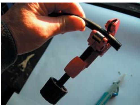
*photo 3 : dénuder au moyen d'un petit coupe tuyau*
