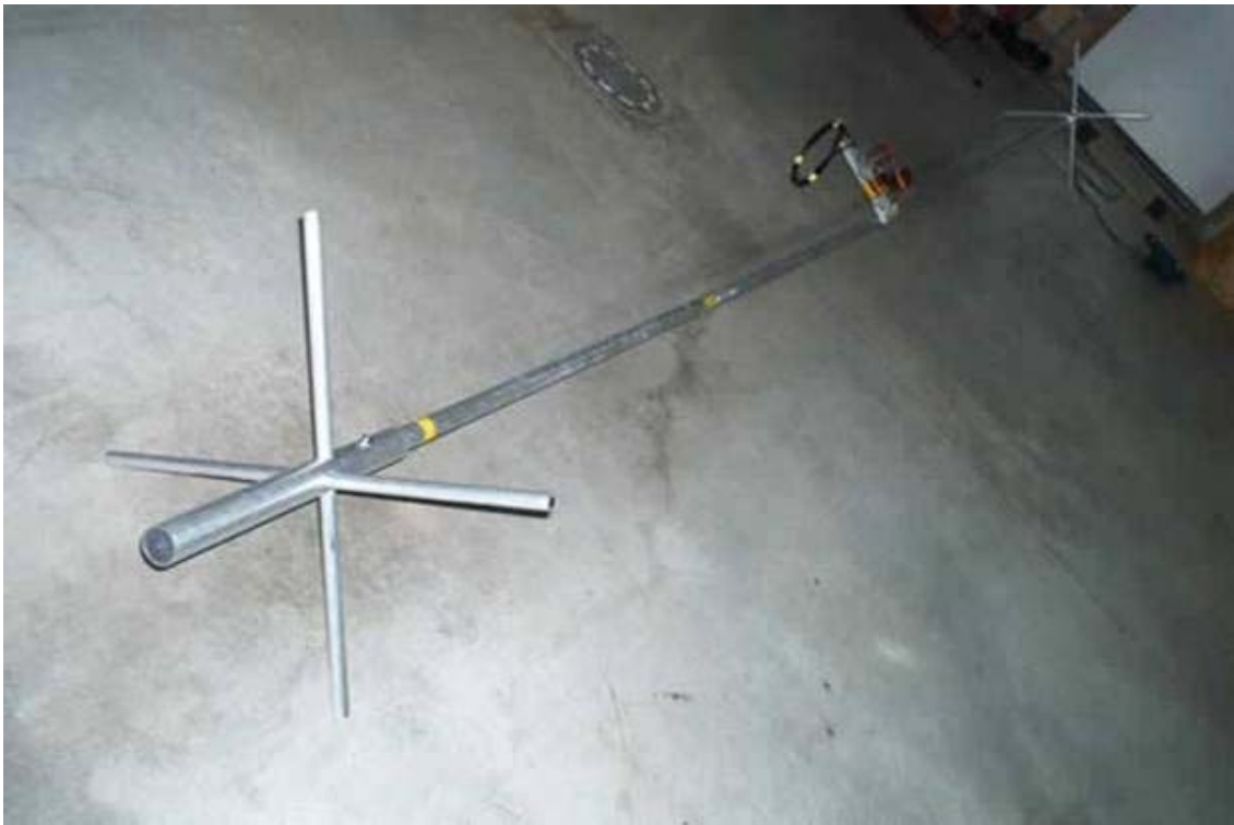
Le dipôle vertical assemblé, ici dans sa version pour les dix mètres.
