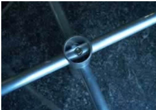
Le dipôle vertical assemblé, ici dans sa version pour les dix mètres.
