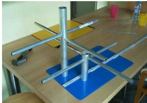
Le dipôle vertical assemblé, ici dans sa version pour les dix mètres.
