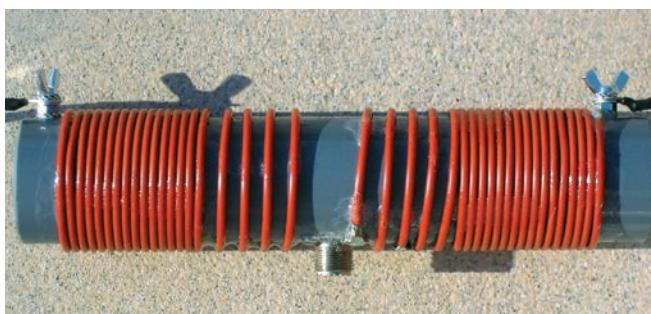
Nu gaan we de spoelen wikkelen. Knip hiervoor een lengte van 7 m VOB draad middendoor. Bevestig het begin van een eind op de SO-239 d.m.v. een draadtong met oog, en wikkel 20½ windingen rond de buis. Nabij het centrum moeten de wikkelingen onderling wat afstand hebben, voorbij 1/3 van de voortgang mogen ze strak tegen elkaar komen. Doe dit met veel zorg, want straks gaan we hetzelfde moeten doen aan de andere kant, volledig symmetrisch.
