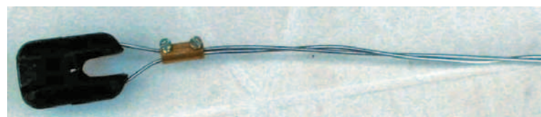
Foto 5. Voorlopige constructie om de bevestiging van de draad aan de isolator af te stellen. – Photo 5. Montage provisoire pour le réglage du fil sur son isolateur.
