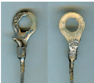
Foto 3. (Overvloedige) solderen van de draad met een oog in gegalvaniseerd staal. Merk op hoe het soldeer over de draad is gevloeid.
