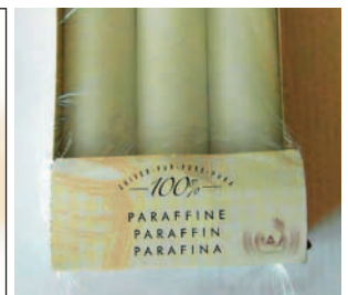
Fig. 9. RF-test de la paraffine (pour tout rendre étanche dans le boîtier): un verre d'eau comme 'charge' pour le magnétron et ensuite la paraffine. Après une minute la paraffine reste froide.
