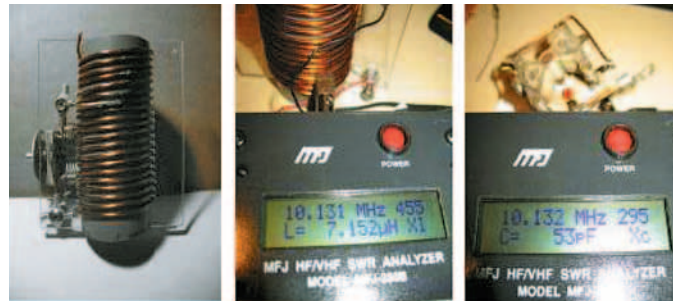
Fig. 7. Illustrations du circuit LC. Montage sur plaque plexi et mesure des éléments L et C.
