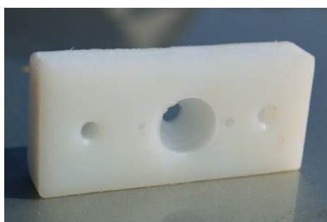
Fig. 9. Het voorgedraaide stukje plastic en de montage van de SO-239 en 2 M5x25 bouten.
