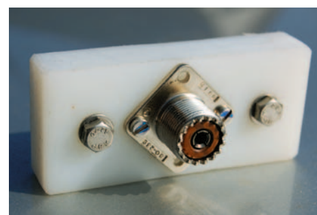
Fig. 9. Le morceau de plastique foré pour le montage du SO-239 et des 2 écrous M5x25.
