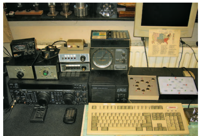
Fig. 9. De oude bediening met draaischakelaar en groene knop staat bovenop de transceiver. Bovenaan rechts op de foto de bediening met drukknoppen en die met aanraakschakelaars.
