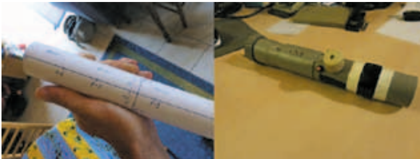
Foto 3. Mechanische opstelling van de drukknoppen en potentiometer
