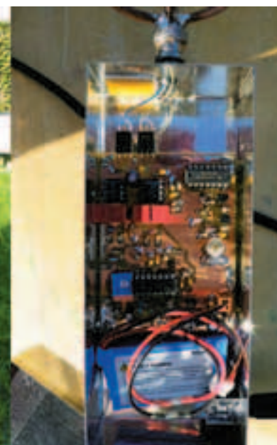
Foto 11. (a) Verticale antenne met meetopstelling, (b) Inwendige van de veldsterktemeter.
