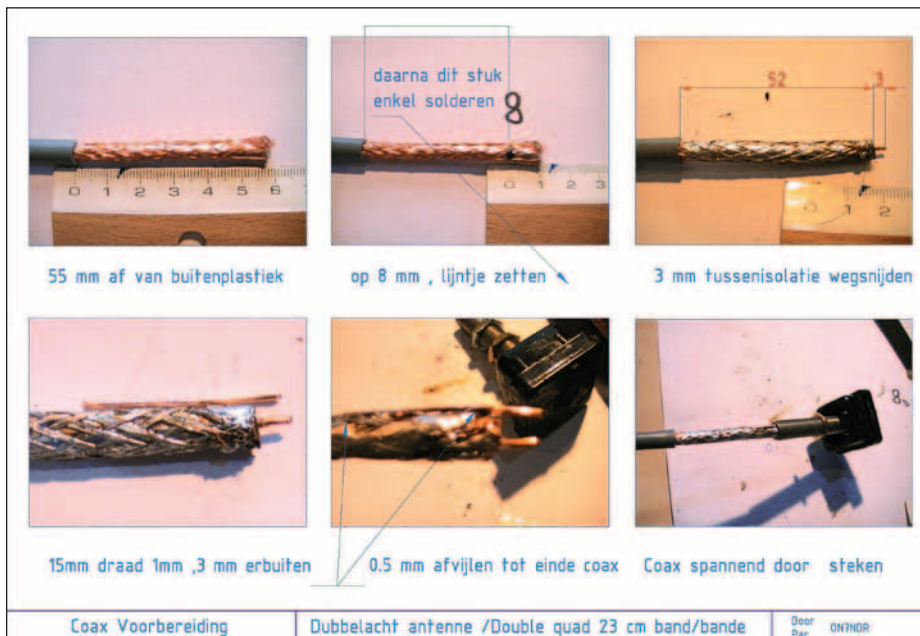
Fig. 6. Préparation du câble coaxial.
