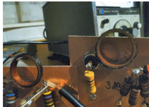
Eerste probeersel. Bifilair gewikkelde weerstandsdraad op rolletjes. Premier essai. Un fil de résistance enroulé bifilairement sur des rouleaux.
