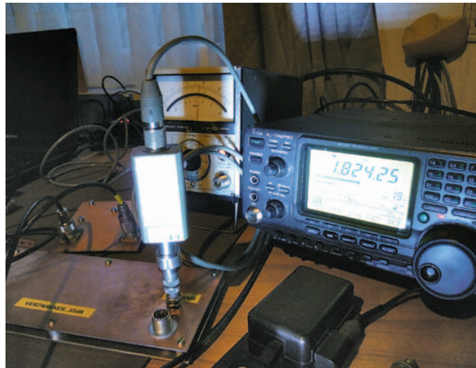
Foto van de meetopstelling (met de HP 435B Powermeter met sensor tot 18 GHz). De transceiver leverde zijn maximum vermogen (100 W) op 160m doorheen de 6 dB (5,62 dB) verzwakker in serie met de 32 dB (31,9 dB) verzwakker, resulterend in 17,5 mW aan de uitgang.
