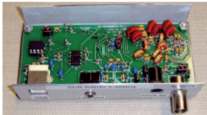
Fig. 19. De SDR-ontvanger van ON1BES, ingebouwd in eigen behuizing
