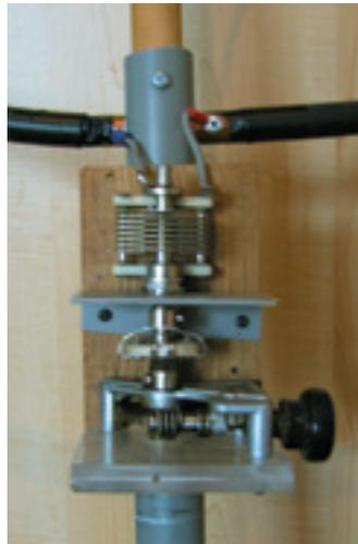
De tuning wordt verfijnd door gebruik van een wormwiel. Dit is echt nodig, zoniet gebeurt de afregeling te grof en ben je zo voorbij het resonantiepunt.
