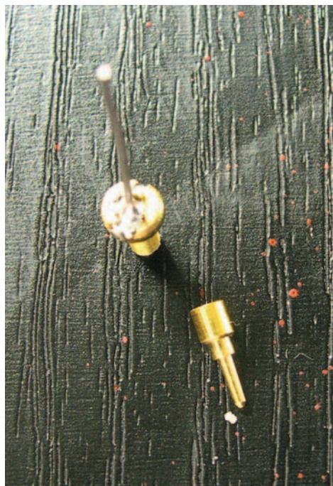
Fig. 2: La vis munie de son bout de fil rigide et la broche dorée de la BNC.
