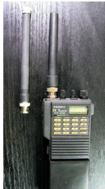
Fig. 8: comparaison de l'antenne d'origine et de l'antenne retractable.
