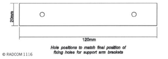
La position des trous de vis n'a pas été précisée car elle dépend des fixations sur le bras de la parabole.
