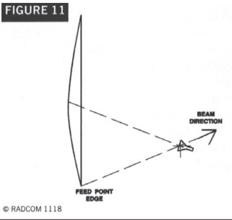
De azimuthrichting van een gekantelde offset-schotel kan raadselachtig lijken, maar wordt in feite beschreven door de lijn die de voedingskant met het midden van de hoornantenne verbindt (zie **figuur 11**).
