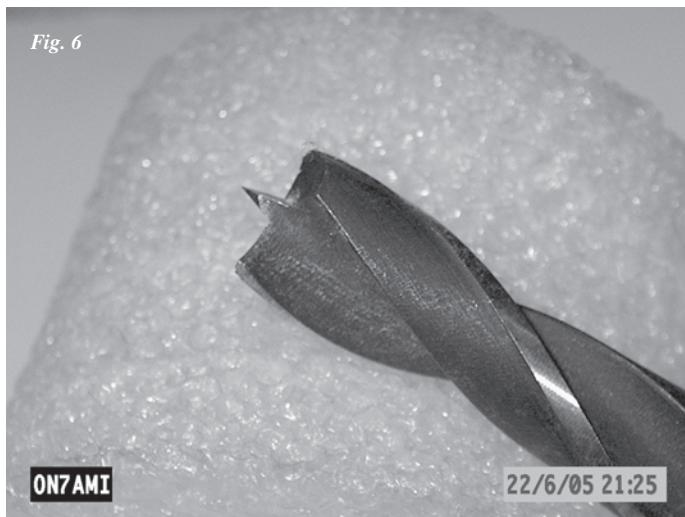
Vergeet niet om het materiaal te ondersteunen met een houten latje (**fig. 7**), anders kan het knap moeilijk worden en riskeer je het materiaal stuk te trekken als de boor erdoor gaat. Beschik je niet over een boor met platte kop, span dan onder en boven de plaat twee blokjes hout en boor door het hout en het blik.
