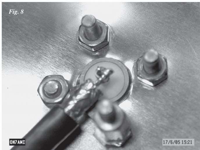
puisse pas s'effilocher. Ce blindage est alors soudé à un petit morceau de métal coincé sous l'écrou inférieur droit, le petit bout de fil de l'âme du coax étant soudé sur le connecteur.
