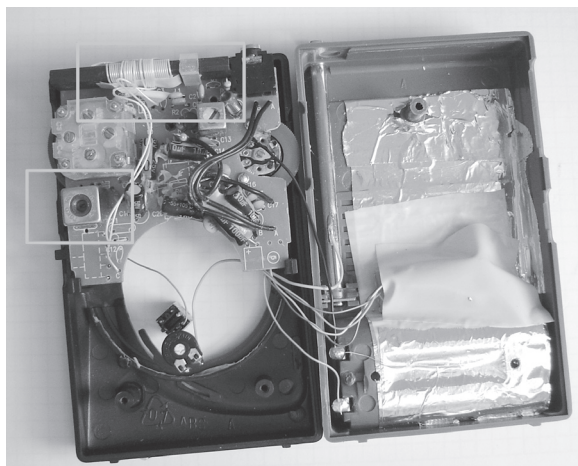
Fig. 4. Barreau de ferrite rebobiné et self d'oscillateur montée.
