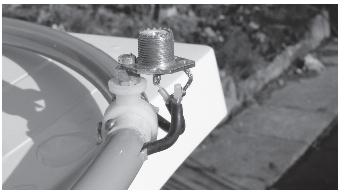
Fig. 20 Le couplage est effectué par une loop symétrique de environ 1/5 de l'antenne.
