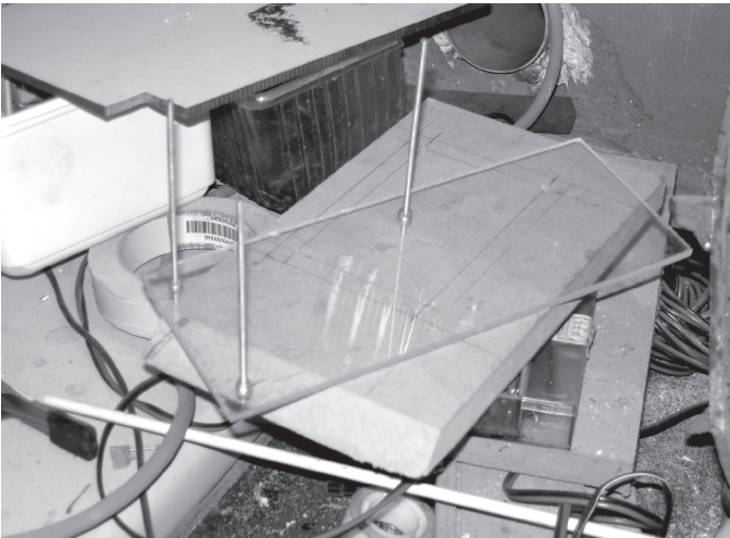
Fig. 7 Le boîtier en plexi avec les tiges filetées. Fig. 7 De condensatorbehuizing in plexiplaat met draadstangen
