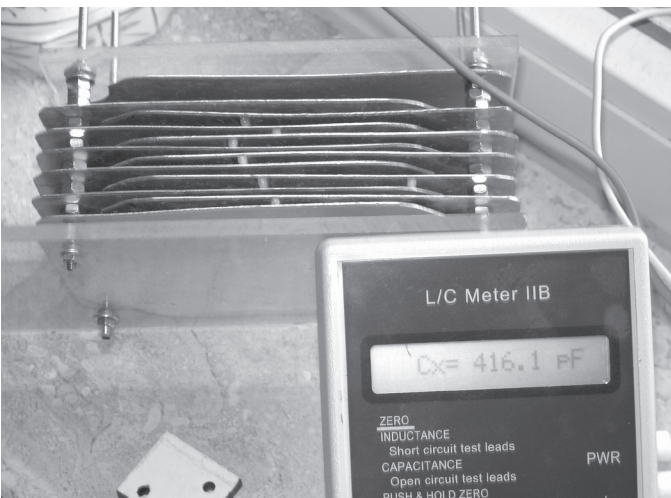
Fig. 9 Mesure du condensateur Fig. 9 "Meten is weten"
