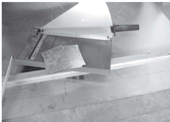
Fig. 4 Découpe des fines plaques d'aluminium. Fig. 4 Snijden van dunne aluminiumplaatjes.
