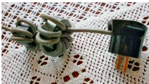
**Zicht op de twee wikkelingen op de ringkern met hoge permeabiliteit. Deze mag open en bloot geplaatst worden, de draad beschermt de kwetsbare ferriet. In geval van breuk kan men de brokken lijmenv met "super-glu".**
