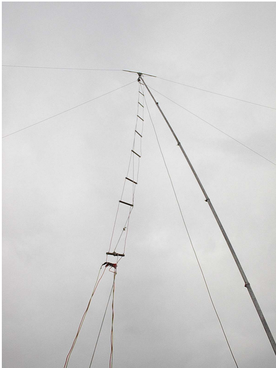
De telescopische mast met dipolen en ladderlijn
